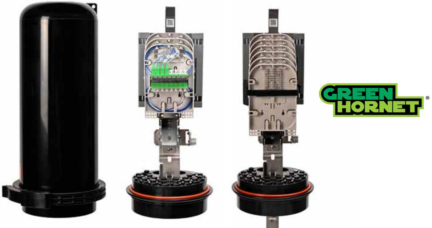
El G6N representa la evolución de la línea de productos G6 heredada pero con la nueva plataforma Universal Splice Tray (UST). El G6N puede acomodar hasta seis (6) UST con capacidad de empalme de fibra única 216F. Un mamparo SC-APC de 16 puertos está disponible para usar como terminal de caída. El domo de 15" proporciona un amplio espacio para la pila de bandejas de empalme y el enrutamiento de fibra al mismo tiempo que brinda una solución completamente sellada e impermeable.
